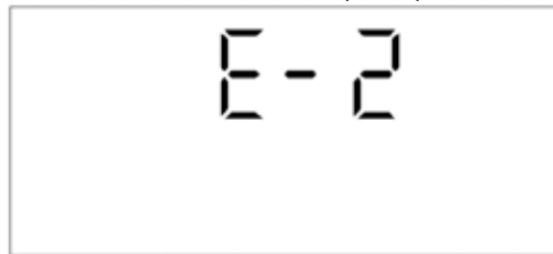
รูปที่ 9: หน้าจอแสดงผลสัญญาณเตือนความผิดปกติขององค์ประกอบความร้อน
